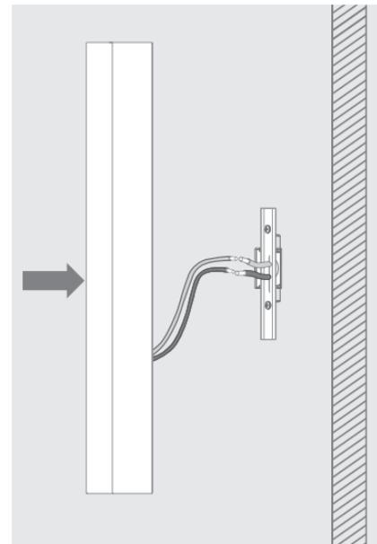
**PASSO 4.** Encaixe a luminária no suporte, tomando cuidado para não pressionar a emenda e os cabos. Aplique força contra a superfície de instalação de forma **linear**.
